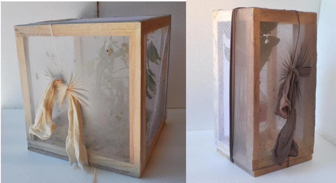
**Figura 1.** Jaulas entomológicas de 30X30X30 y 15X15X30 cm (de madera y tul) para conservar ortópteros en campo o para mantenerlos en laboratorio.
